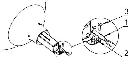
3. Встановити світильник на торшерну опору діаметром 60 мм, затягнувши три гвинта (4).
