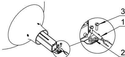
3. Установить светильник на торшерную опору диаметром 60 мм, затянув три винта (4). Усилие затяжки винтов не более 4,5Нм.
