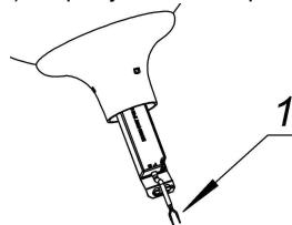
2. Зафіксувати мережний провід (1) пристроєм затиску кабелю (2), закрутити гвинти (3).
