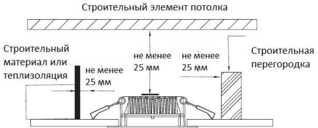
Рисунок 2 - Схема установки светильника в потолок
