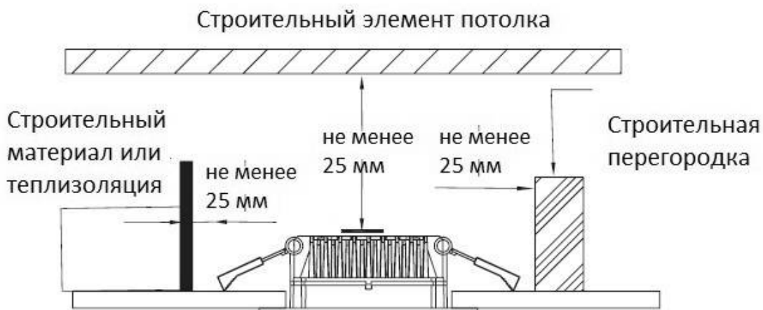
Рисунок 2 - Схема установки светильника в потолок
