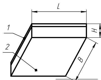
Рисунок 2: ДПО46-48; 1 .Корпус в сборе, 2. Рассеиватель
