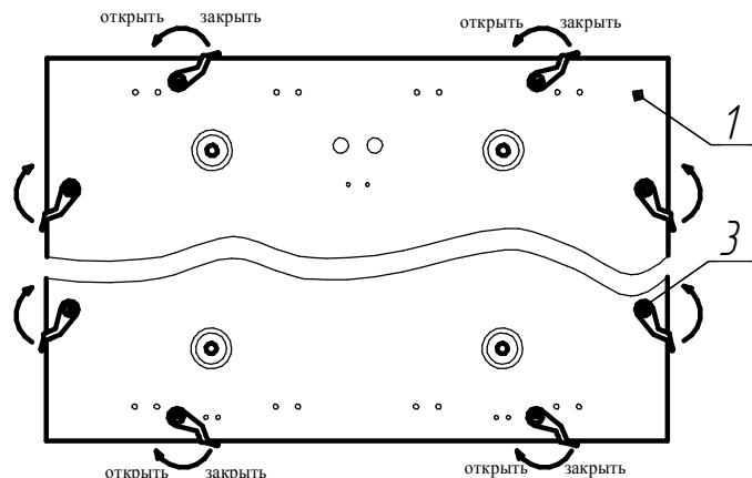
Рисунок 1. 2: ДПО46-48; 1. Корпус в сборе; 3. Зажим
