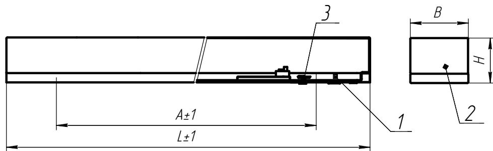
Рисунок 1. ДПО46-19; 38; 76 1. корпус в сборе; 2. рассеиватель; 3. зажим
