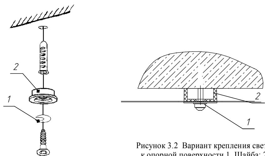
Рисунок 3.2 Вариант крепления светильника
