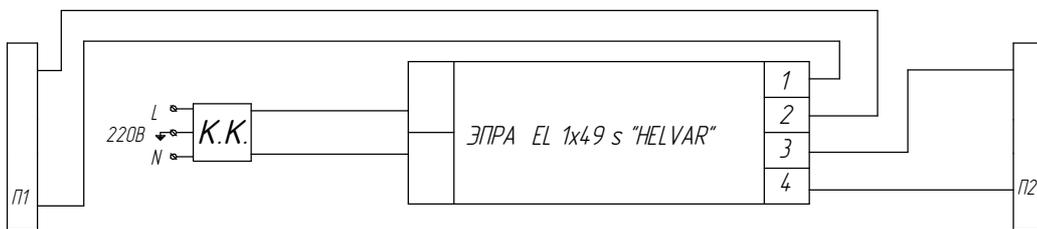
Рисунок 11. ЛСО02-1x49 Universal, схема электрическая с ЭПРА
