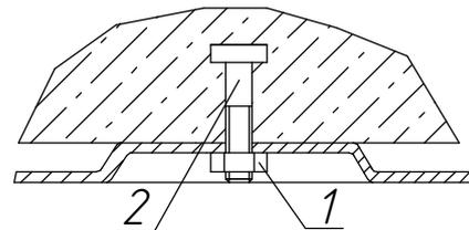
Рисунок бб. Крепление светильника
