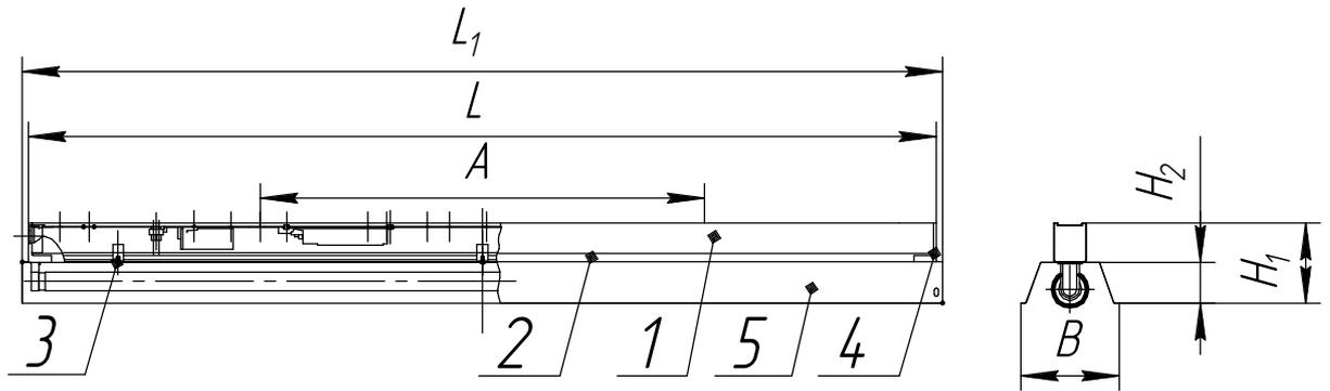
Рисунок 2. 1. Корпус в сборе, 2. Крышка, 3. Винт, 4. Крышка, 5. Отражатель.
