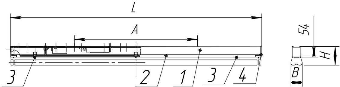
Рисунок 3. 1. Корпус в сборе, 2. Крышка, 3. Винт, 4. Крышка.
