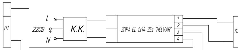
Рисунок 7. ЛСО02-1x28-012 Universal, схема электрическая.
