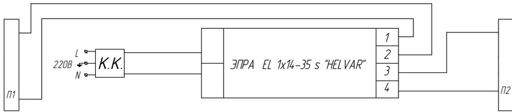
Рисунок 9. ЛСО02-1x35-012 Universal, схема электрическая.
