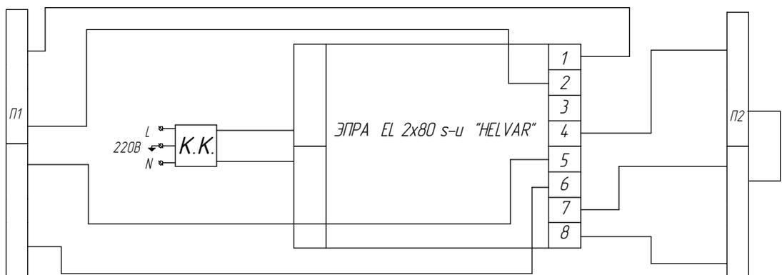
Рисунок 12. ЛСО02-2x80 Universal, схема электрическая с ЭПРА
