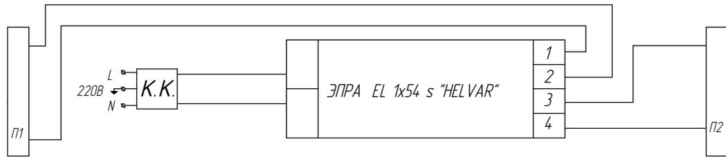
Рисунок 9. ЛСО02-1x54-012 Universal, схема электрическая.
