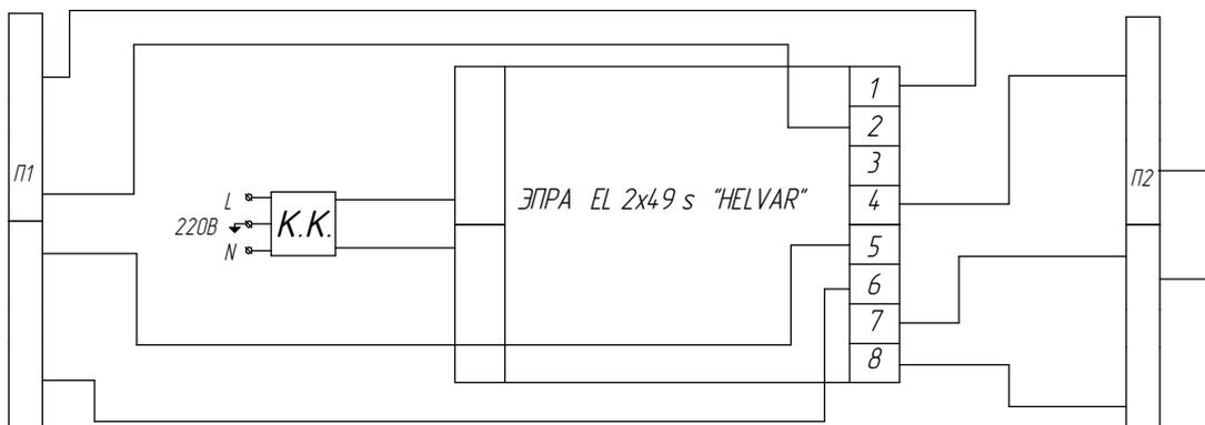
Рисунок 12. ЛСО02-2x49 Universal, схема электрическая с ЭПРА
