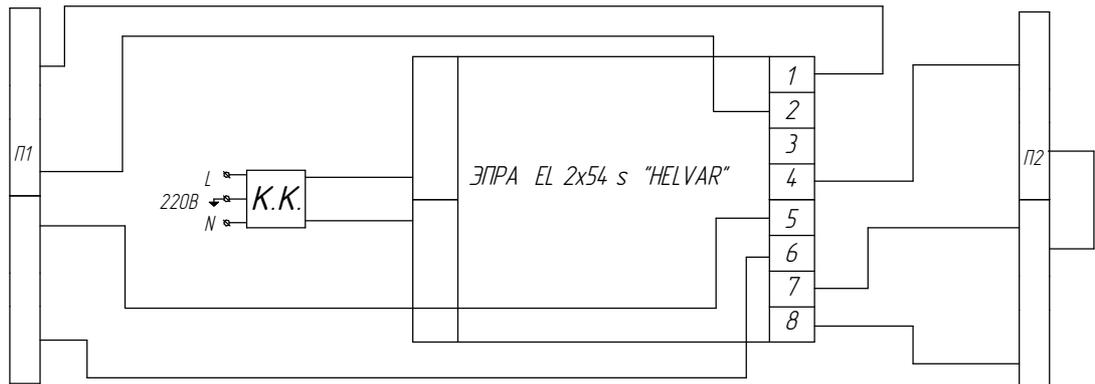
Рисунок 10. ЛСО02-2x54-012 Universal, схема электрическая.
