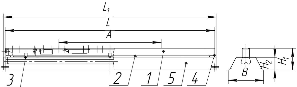
Рисунок 4. 1. Корпус в сборе, 2. Крышка, 3. Винт, 4. Крышка, 5. Отражатель.
