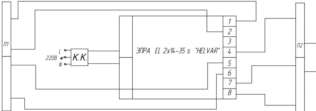
Рисунок 10. ЛСО02-2x35-012 Universal, схема электрическая.
