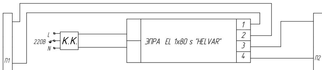
Рисунок 11. ЛСО02-1x80 Universal, схема электрическая с ЭПРА
