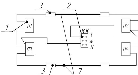
Схема 1.2 - с двумя лампами "типа 1"
