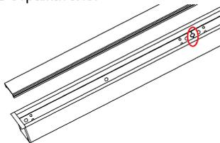
6. В отверстия на корпусе установить монтажный крепеж
