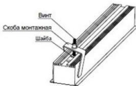
7. "Подключить сетевой провод к драйверу в соответствии с указанной полярностью. Корпус установить в вырез в потолочной нише. Закручивая два винта М4х30 развернуть скобы крепления, согласно рисунку. Установить отражатель обратно в корпус светильника. Закрутить винты крепления до достижения плотного прилегания корпуса к потолку."
