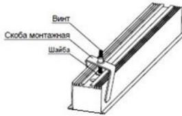
7. Підключити мережевий провід до драйверу відповідно до зазначеної полярності. Корпус встановити в виріз в стельовій ніші. Закручуючи два гвинти M4x30 розгорнути скоби кріплення, відповідно до малюнку. Встановити відбивач назад в корпус світильника. Закрутити гвинти кріплення до досягнення щільного прилягання корпусу до стелі.
