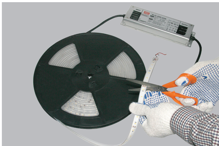
1. Отрезать отрезок LED ленты необходимой длины
