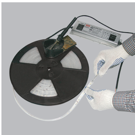
5. Плотно прижать силиконовую крышку к концу отрезка
