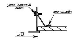
Установка в подвесной потолок при помощи пружинных кронштейнов:
