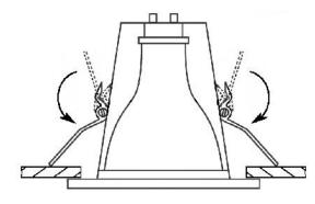
Установить отражатель (при необходимости), закрепив его гайкойбарашком.
