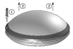
2 Снять отражатель:
