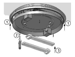
Установить рассеиватель и зафиксировать его винтами.
