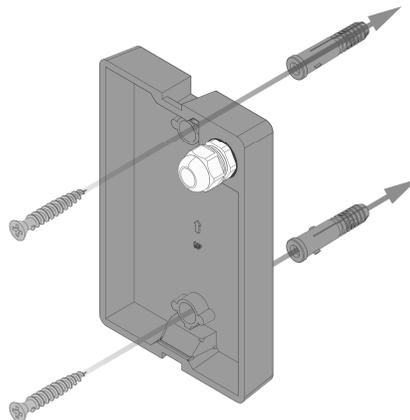
5. Разъединить коннектор и подключить его к кабелю питания соблюдая полярность. Затянуть гайку гермоввода. (кабель не показан)
