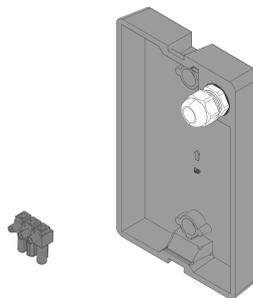
6. Подключить коннектор к светильнику, установить светильник на монтажную крышку и зафиксировать его с помощью 2 винтов.
