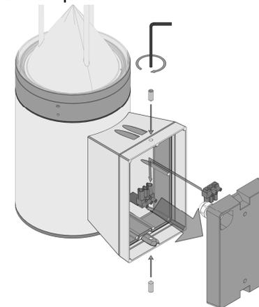
7. Шестигранным ключом 3 мм (в комплект не входит) выкрутить 3 винта в центральной части светильника и снять светорассеивающую колбу.
