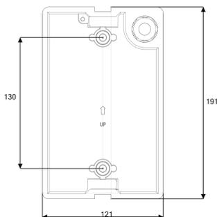
4. Продеть кабель питания в гермоввод и закрепить крышку на стене с помощью 2 винтов диаметром 5-6 мм. Рекомендуется использовать комплект крепления X1 арт. 2995000010 (не входит в комплект).
