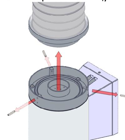
8. Установить лампу с цоколем E27 мощностью не более 60 Вт, вернуть светорассеивающую колбу и закрепить ее винтами. Максимальный размер лампы – 230x71 мм.
