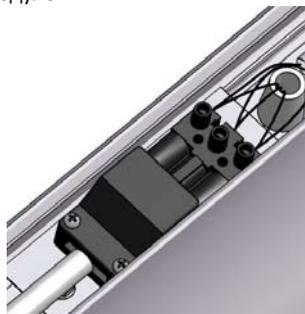
11 Для установки лампы приподнимите рассеиватель и сдвиньте его над рассеивателем соседнего модуля.
