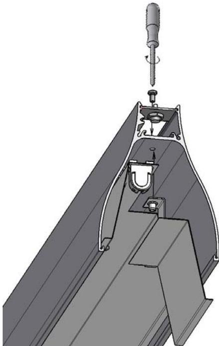
9 К открытым торцам стартового и последнего конечного модулей прикрепить тоцевые крышки винтами с потайными головками M4x10 с внутренним шестигранником – 2 шт. (1) и винтами-саморезами 2,5x12 – 2 шт. (2).
