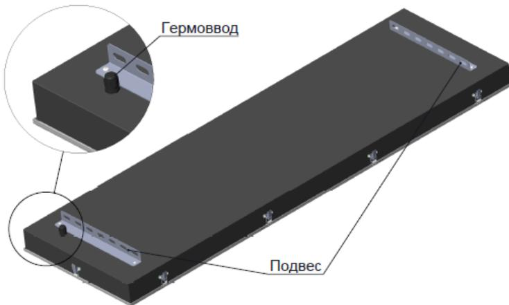
2. Проверить надежность фиксации гермоввода в корпусе светильника. Завести питающий провод через гермоввод, подключить провода к клеммной колодке в соответствии с указанной на ней полярностью и герметизировать провод, закрутив гайку гермоввода.
