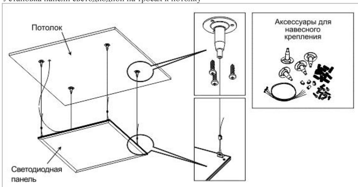
Схема монтажа светодиодной ультратонкой панели, вариант установки: подвесной на комплекте тросов, накладной монтаж
