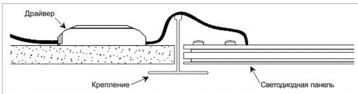
Схема установки ультратонкой светодиодной панели, вариант установки: встраиваемый в потолок типа Армстронг. Панель укладывается в ячейку вместо плиты. Драйвер устанавливается на поверхность потолочной плиты в соседней ячейке.
