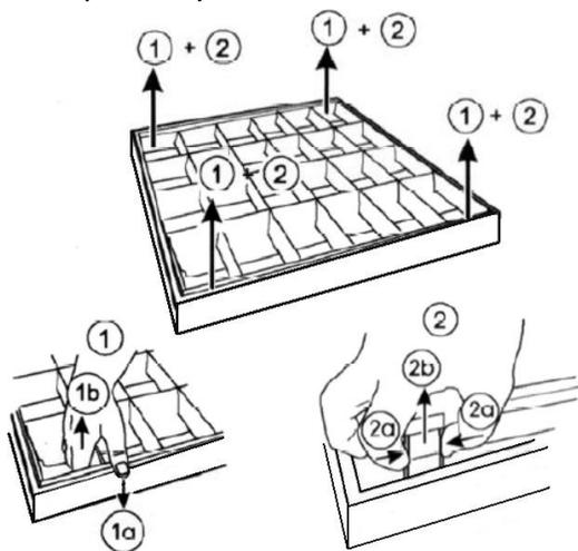
3. Вщелкнуть опоры в корпус светильника:
