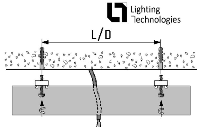
6. Подключить сетевой провод к клеммной колодке в соответствии с указанной полярностью:
