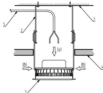
3. Отрегулировать высоту подвеса таким образом, чтобы декоративная рамка светильника была на уровне потолка "Грильято" (x).
