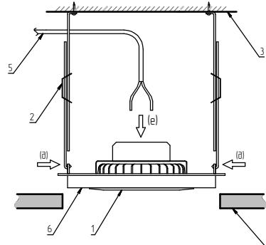
3. Отрегулировать высоту подвеса таким образом, чтобы лицевая поверхность переходника была на уровне потолка "Грильято" (x).
