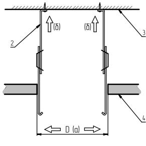
2. Смонтировать светильник на установленные подвесы АП-Г (b). Подключить светильник к электрической сети (z) в соответствии с требованиями технического паспорта на светильник.
