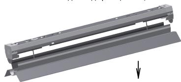
2. Разметить место для установки корпуса светильника.
