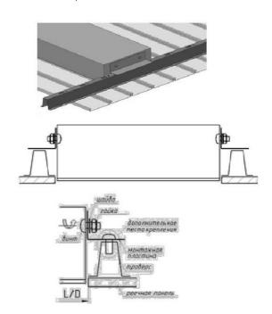
Для облегчения обслуживания светильника (монтаж и демонтаж рассеивателя), рекомендуется дополнительно закреплять монтажные пластины на траверс винтами саморезами, при необходимости, просверлив в гребенке (траверсе) отверстия требуемого диаметра.
