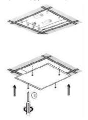
6.3. Рассеиватель одевается на корпус светильника.
