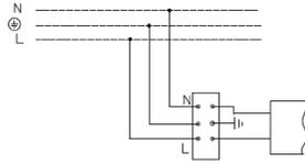
2. Резервтік қуаттандыру блогы бар қуаттандыру желісіне қосу сұлбасы : (сур. а - Резервтік қуаттандыру блогы).
