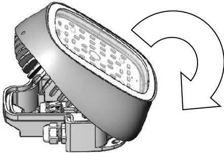
2. Завести сетевые провода через гермоввод в корпус светильника и закрепить светильник на опорной поверхности с помощью комплекта крепежа Х3 (не входит в комплект поставки).
