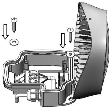
3. Подключить сетевой провод к клеммной колодке в соответствии с указанной полярностью.
