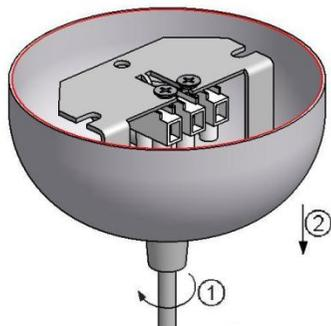
2 Установить втулки подвеса (1) и пластик потолочной чашки на поверхности потолка, продеть концы тросов через отверстия в крышках втулок подвеса (2) и закрепить их во втулках (3). Для светильников с регулируемым ЭПРА установить вторую потолочную чашку для управляющего кабеля.
