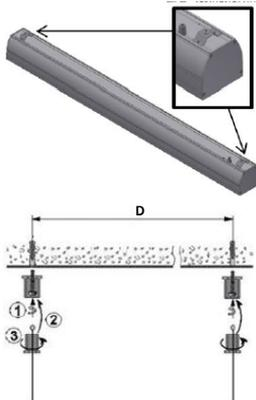
5. Вставити в пази та прикрутити сполучну пластину зверху корпусу (для установки світильника в лінію).
