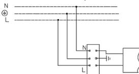
2. Схема подключения светильника к питающей сети с регулируемым драйвером и модулем ME6-NF.
