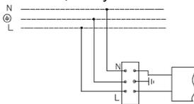
2. ME6-NF модулі бар және реттелетін драйвері бар қоректендіруші желіге шамшырақты қосу схемасы.
