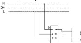
2. Схема підключення світильника до мережі живлення з регульованим драйвером та модулем ME6-NF.
