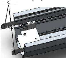
4. Підвісити світильник на тросах, вставивши їх кінці в грипери (самозатискаючі тримачі). Відрегулювати висоту та горизонтальність підвішеного світильника.
