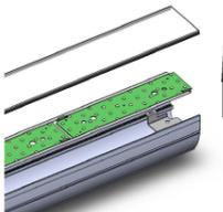
2. На торец первого и последнего светильника в линии установить торцевую крышку (в комплект светильника не входят) и закрепить 4-мя винтами- саморезами.
