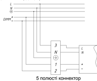
4-сурет. Диммирлеуші драйвері бар электрлік қосылыстардың сұлбасы
