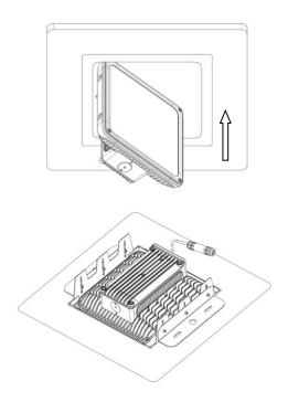
4. Произвести регулировку датчика движения (для модификаций с датчиком) предварительно сняв защитное стекло (см. инструкцию по регулировке датчика движения).
