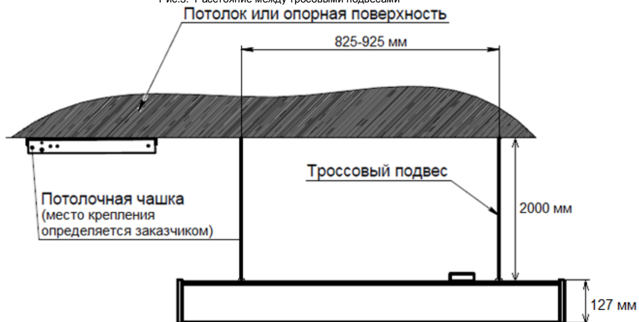
Рис.3. Расстояние между тросовыми подвесами
